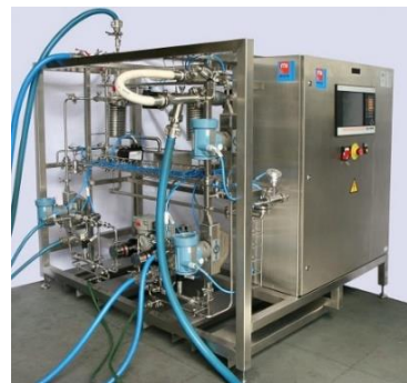
Figure 11 : Exemples de systèmes de réacteurs tubulaires modulaires. Haut : Flowid [3] - Bas : Microinnova [4]
